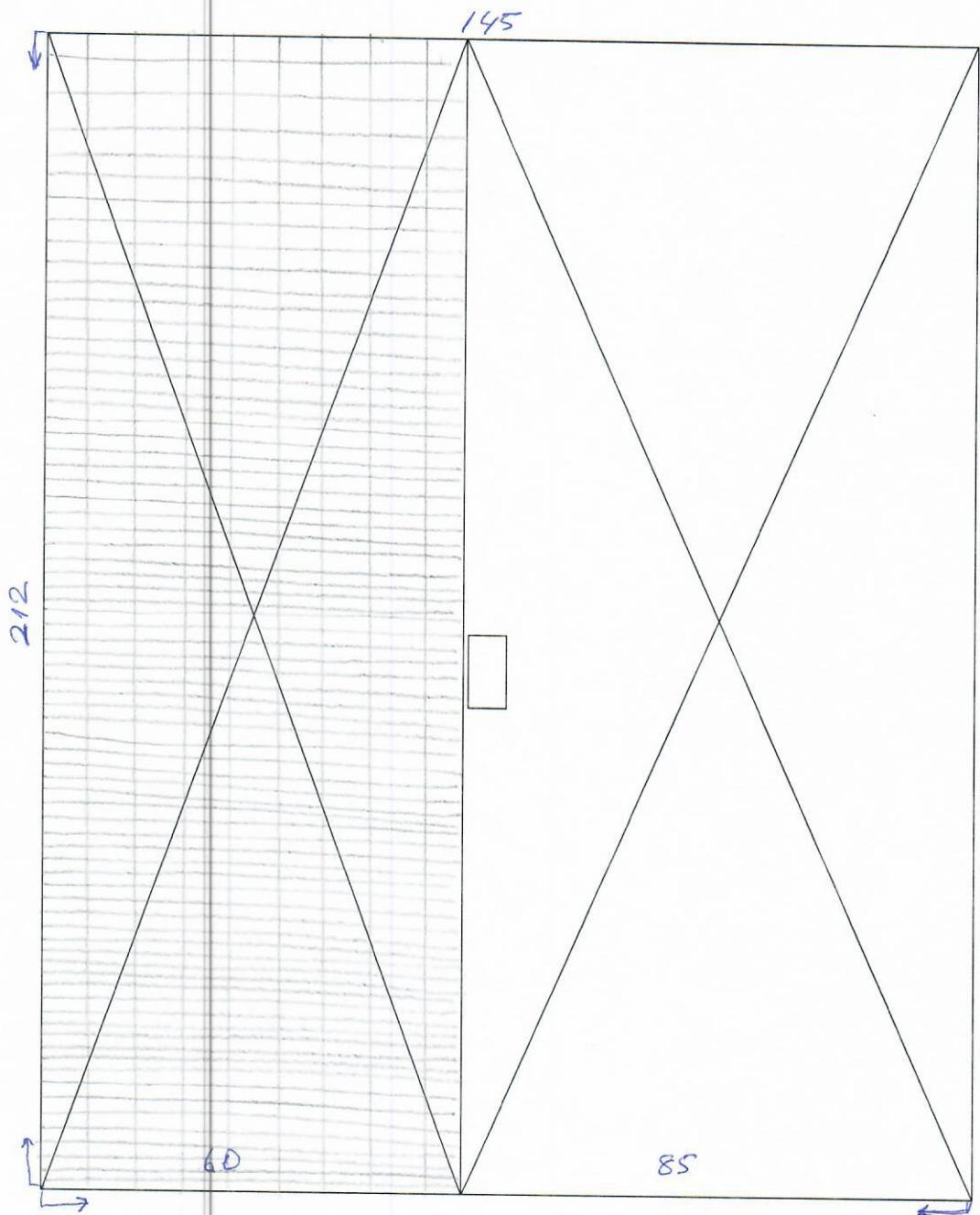
Hamur TSM Binası Jeneratör mahalli kapı panjurunun yetersiz olmasından, sıcak havalarda jeneratörün aşırı ısınmasından dolayı 2021 yılı yaz döneminde sık sık arızalandığı, aynı sıkıntıların tekerrür etmemesi ve jeneratörün sağlık bir şekilde çalışması için yukarıda belirtilen şekilde kapıya izgara teli takılması teknik açıdan uygun olarak değerlendirilmiştir.
